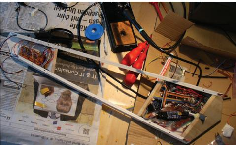
9. Alle elektrischen Bauteile an den Stromkreis anschließen. Fader, Taster, Potentiometer, Joystick und Gravitationssensor mit den Inputs des Boards (hier JeeNode SMD) und LED's mit den Outputs verkabeln.
